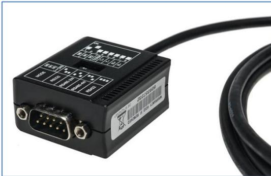
Die Stellung der DIP-Schalter für im Jahre 2017 von Maple Leaf Stadiums AG gelieferte Anzeigetafeln: M1 = ON (Übertragungsart 2-Draht RS-485), TERM = ON.
