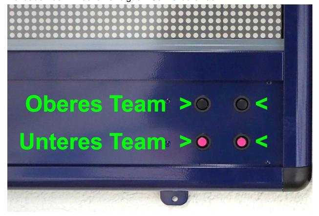
Löschen der Team-Anzeige: Durch gleichzeitiges Drücken der unteren beiden Tasten (mit rosa Klebepunkten bezeichnet) wird die Team-Anzeige gelöscht.
